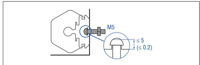
Fig. 11: T-slot nut M5 (part no. 401 602)
